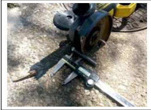
9. Couper la vis de sécurité avec un émeri pierre pour l'insérer de 20 à 25mm dans la douille en comptant les 5mm d'épaisseur de la rondelle.
